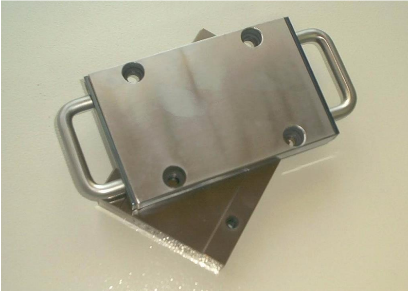
Abb.6: Die O-Ring Prüflabor Richter GmbH besitzt zahlreiche Sätze von DVR-Prüfwerkzeugen mit unterschiedlich tief eingeschliffenen Grundplatten (siehe untere Platte auf dem Bild), so dass der Einsatz von Abstandshaltern entfallen kann.
