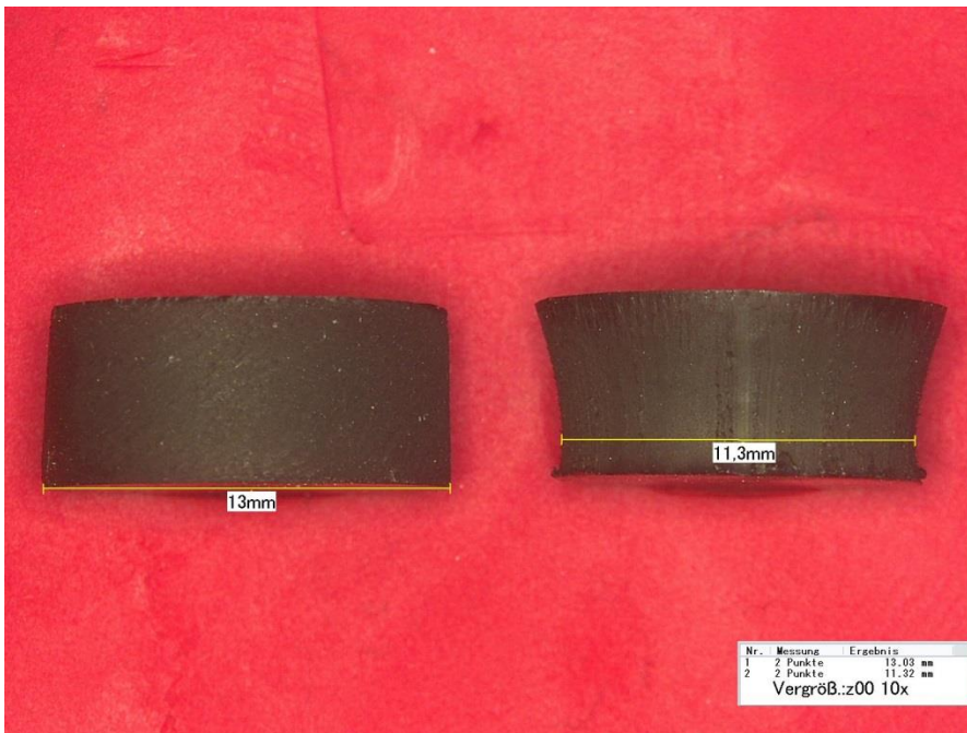
Abb.9: Rechts ist der gestanzte Probekörper erkennbar, links der geschnittene. Im vorliegenden Fall weicht der kleinste Durchmesser des gestanzten Probekörpers (11,3mm) bis zu 13% vom Sollwert (13mm) ab!
