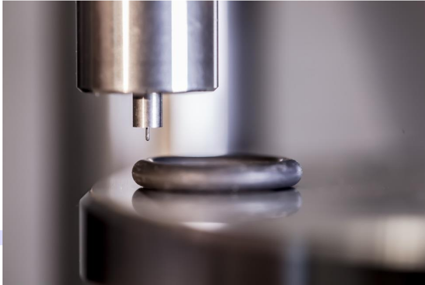
Abb. 10: Härteprüfung an einem O-Ring (Methode IRHD, CM) (Foto: O-Ring Prüflabor Richter GmbH)
