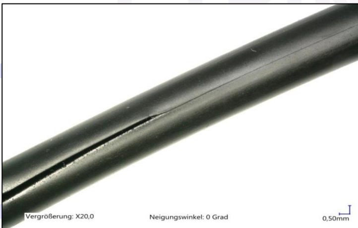
Abb. 7: Montagededingter Riss durch das Einwirken einer scharfen Kante im Einbauraum
