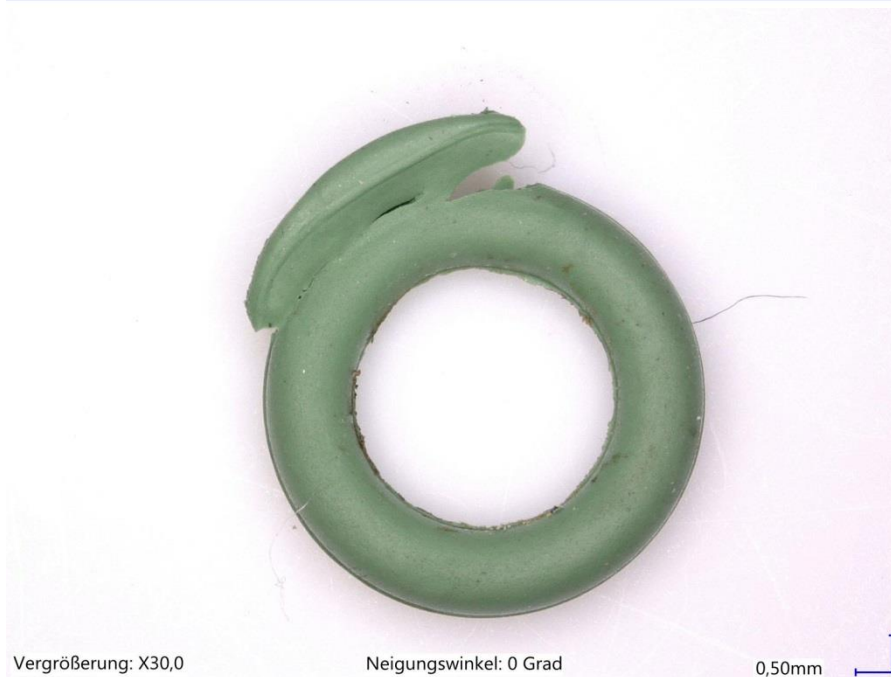
Abb. 3: O-Ring mit, während der Montage, gequetschtem Bereich
