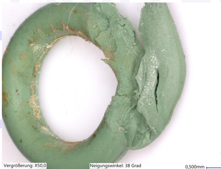
Abb. 5: Durch die Montage abgescherter Teil eines O-Rings
