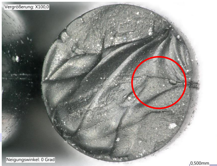
Abb. 10: Gerissener O-Ring wegen eines Vulkanisationsfehlers: Inhomogene, zerklüftete Bruchfläche
