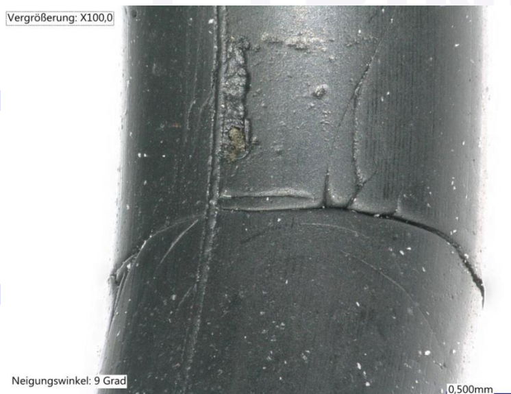
Abb. 11: Herstellungsbedingter Vulkanisationsfehler: Gerundeter Rissübergang
