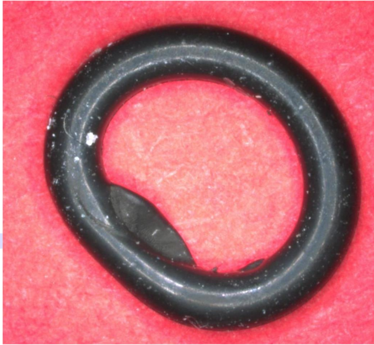
Abb. 2: Quetschung durch Fehlpositionierung der Dichtung
