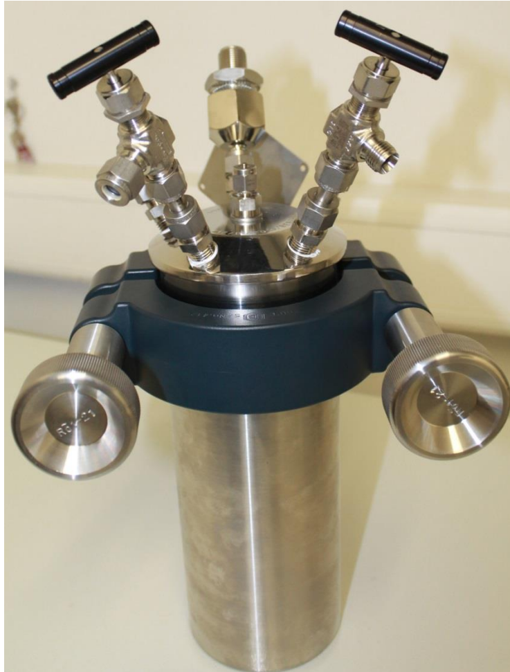
Abb. 3: CO 2 -Hochdruckautoklav, im Bild eine Version ohne Temperatur- und Druckfühler
