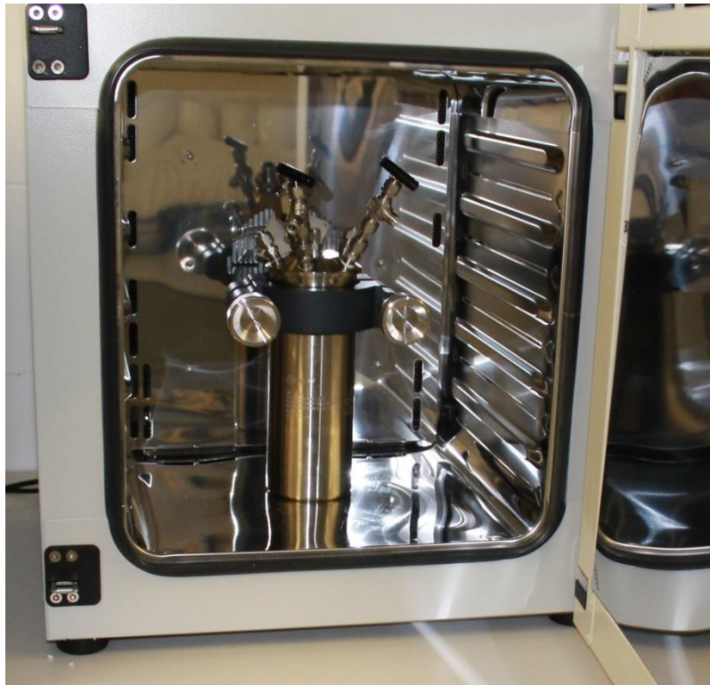
Abb. 1: CO 2 -Hochdruckautoklav im geöffneten Umluftofen
