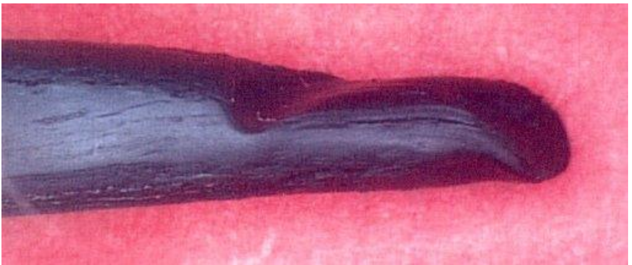
Bild 3: Abscherung durch das Überfahren eines Steuerschlitzes bei der Montage
