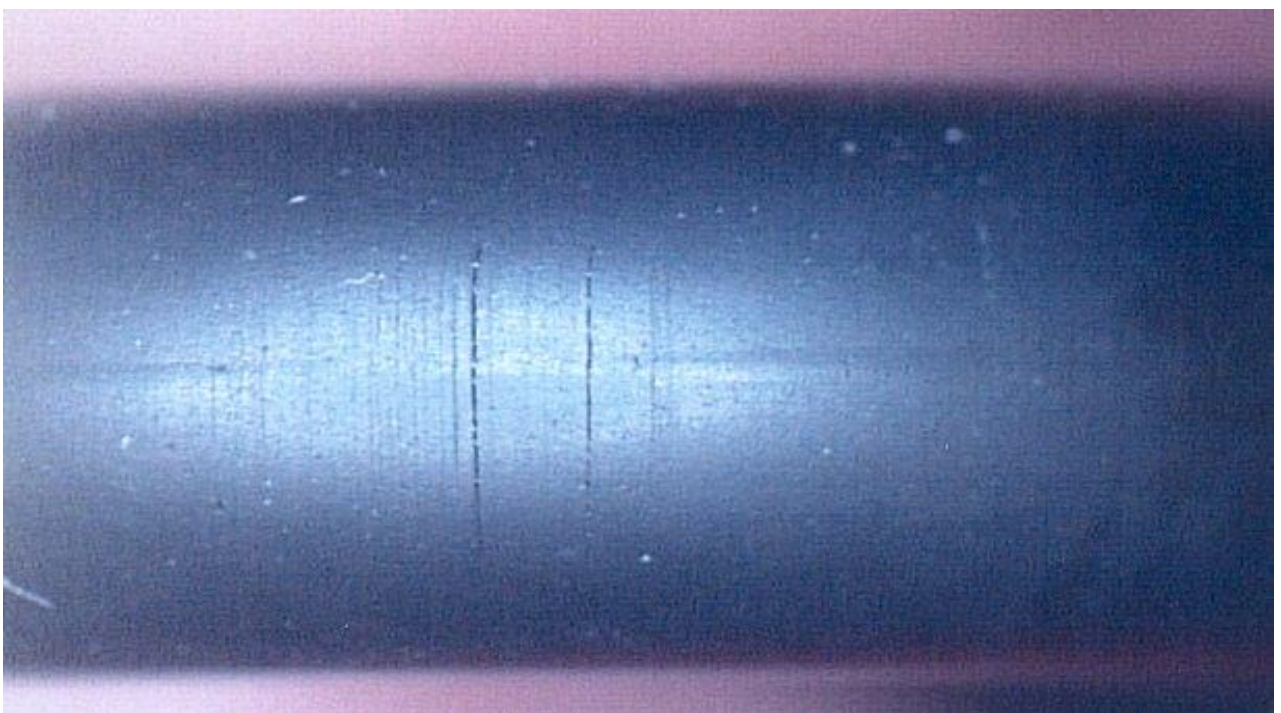
Bild 4: Vorschädigung der O-Ringe bei der Zuführung
