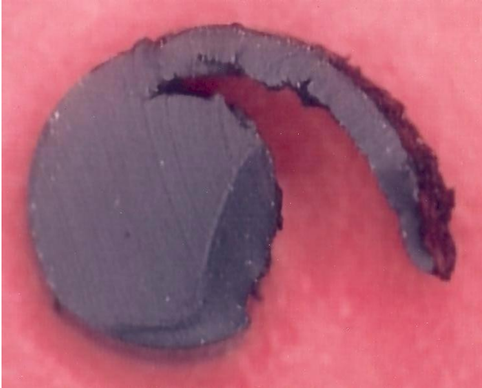
Bild 8: Extrudierter O-Ring (zu großer Spalt)
