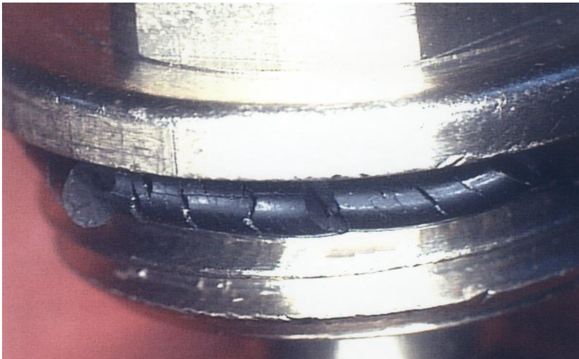
Bild 5: Ozonrisse an einem vormontierten NBR O-Ring nach mehreren Wochen La- gerzeit ohne Licht- und Luftschutz.
