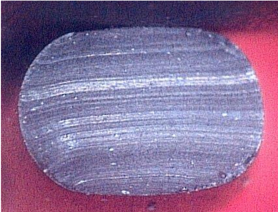
Bild 7: Bleibend verformter O-Ring
