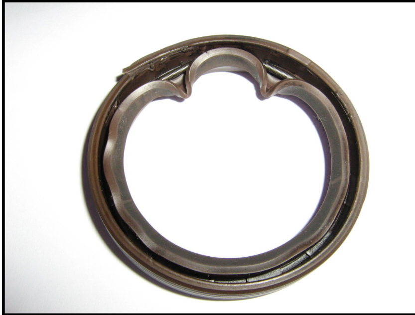
Bild 2-ein durch Quellung ausge- fallener RWDR
