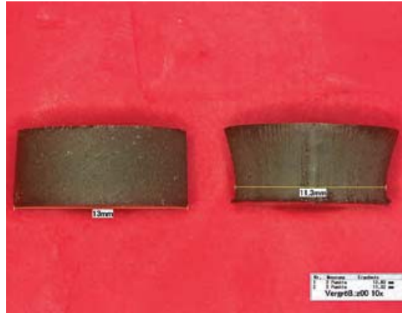
>>10: Rechts ist der gestanzte Probekörper erkennbar, links der geschnittene. Im vorliegenden Fall weicht der kleinste Durchmesser des gestanzten Probekörpers (11,3 mm) bis zu 13% vom Sollwert (13 mm) ab
