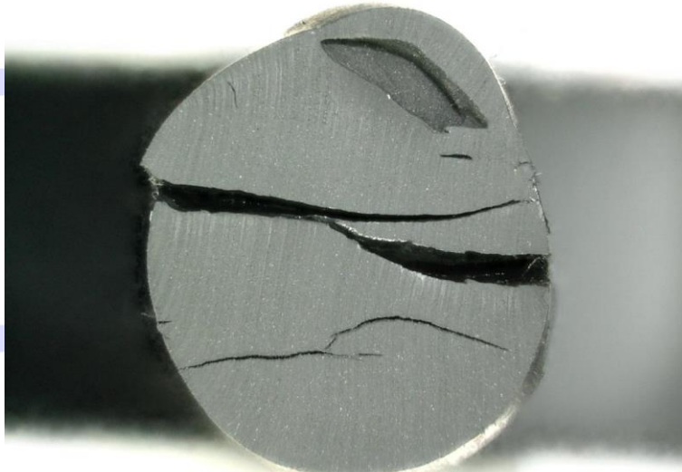
Abb. 2: Risse im Querschnitt durch explosive Dekompression
