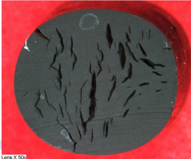
Abb. 3: Explosive Überhitzung: FFKM O-Ring in einer Gleitringdichtung nach 16 bar und 165°C in Wasser: Schädigung entweder durch mehrfaches Überhitzen beim Anfahren oder durch vorübergehenden Trockenlauf
