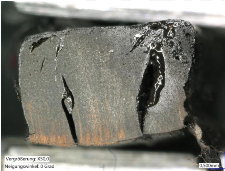
Abb. 4: Innere Risse durch explosive Überhitzung bzw. explosive Verdampfung
