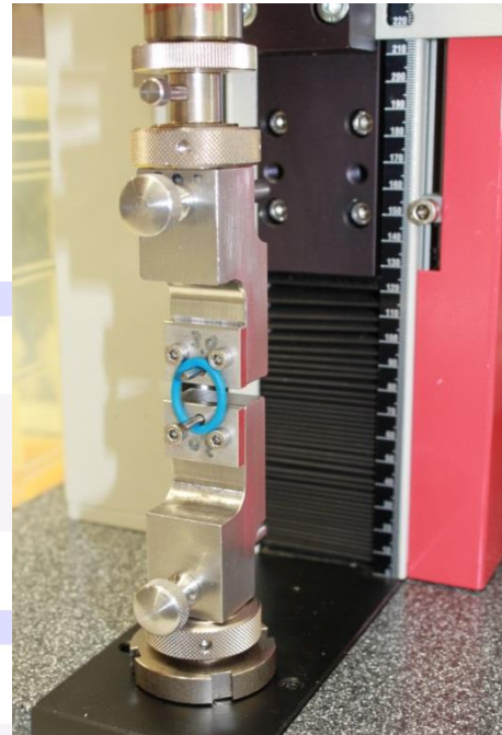
Abb. 9: Zugversuch eines kleinen O-Ringes: Wenn der Einsatz von kugelgelagerten Rollen nicht mehr möglich sind, kommen in der Praxis eingölte feststehende Dorne vor.
