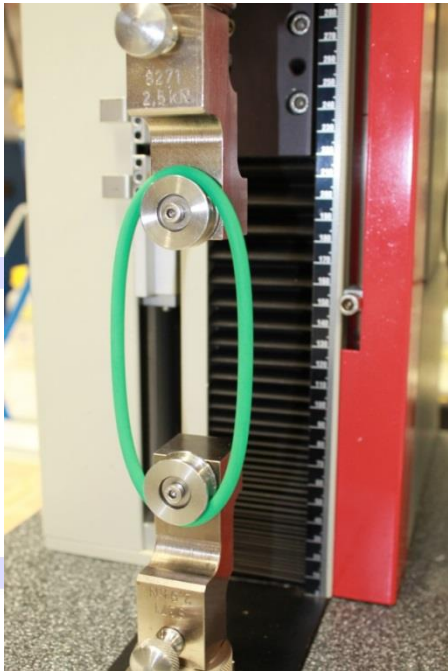
Abb. 8: Zugversuch eines O-Ringes auf kugelgelagerten Rollen (hier nicht angetrieben)
