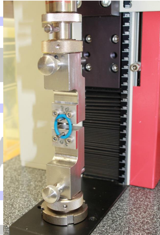
Abb.6: Zugversuch eines kleinen O-Rings: Wenn der Einsatz von kuggelagerten Rollen nicht mehr möglich sind, kommen in der Praxis eingölte feststehende Dorne vor.
