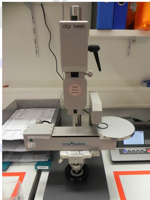
Abb.2: Eines von zwei stationären IRHD, Mikro-Prüfgeräten im O-Ring Prüflabor Richter. Sie besitzen einen lasergeführten Tisch, speziell zur exakten Härtemessung von O-Ringen.
