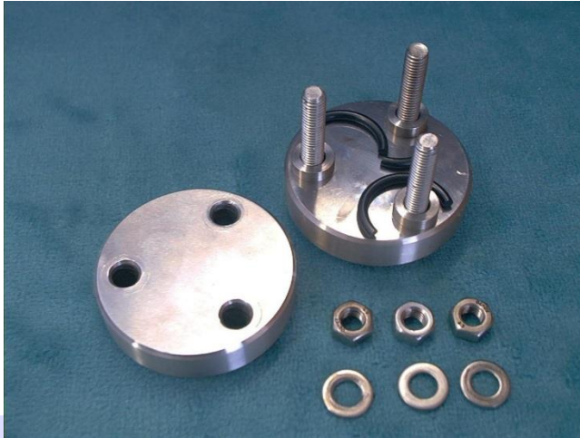
Abb. 4: Plane Platten zur DVR-Messung mit Distanzstücken: Auf der Basisplatte befinden sich drei O-Ring Abschnitte.
