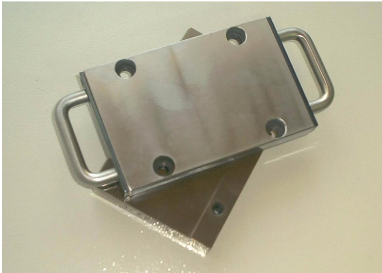
Abb.3: DVR-Prüfwerkzeuge mit unterschiedlich tief eingeschliffener Grundplatte (siehe untere Platte), der Einsatz von Abstandshaltern entfällt
