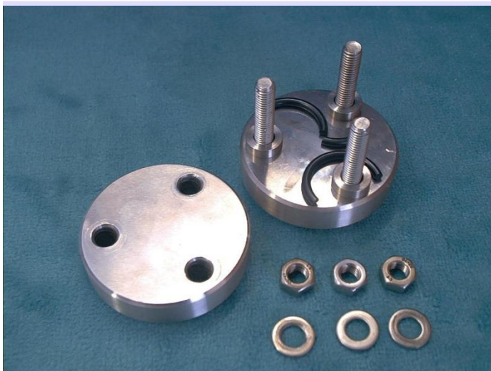
Abb. 4: Plane Platten zur DVR-Messung mit Distanzstücken: Auf der Basisplatte befinden sich drei O-Ring Abschnitte, die sich durch die unterschiedlichen Längen identifizieren lassen. Durch die runde Werkzeugform ist auch eine Einlagerung in flüssigen Medien im Becherglas möglich.
