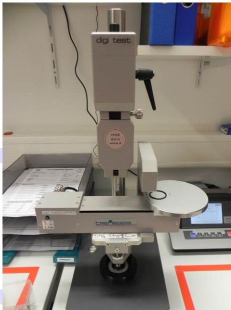
Abb. 1: Stationäres IRHD-Mikro-Prüfgerät mit einem lasergeführten Tisch zur exakten Härtemessung von O-Ringen (Verfahren CM)
