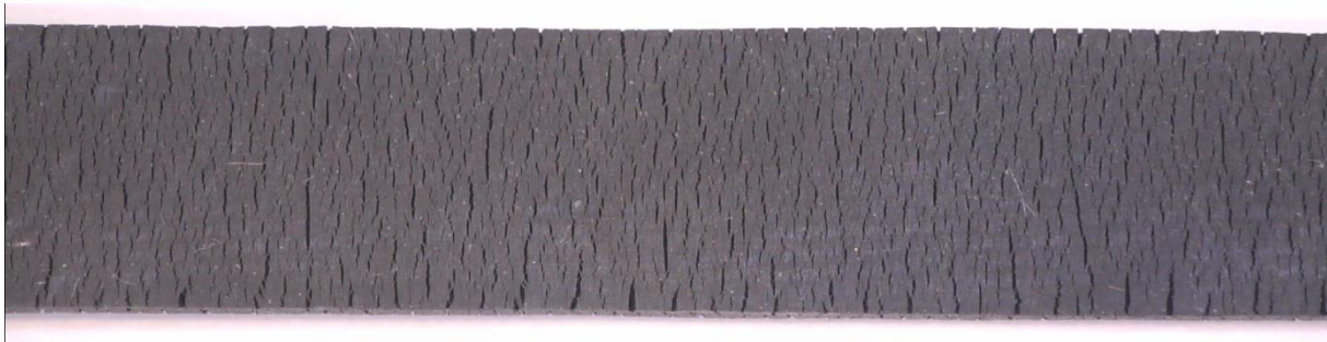
Abb. 6: Beispiel eines Elastomerprobekörpers nach einer Ozonprüfung (Zustand nach 48h / 40°C / 20% Dehnung / 50 pphm Ozonkonzentration / 55% rel. Feuchte): Probe befindet sich noch im gedehnten Zustand und weist lange, mäßig breite Risse auf ( = Stufe 2, bewertet nach DIN 53509) (Vergrößerung 10-fach)
