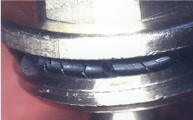
Abb. 1: Vormontierter NBR O-Ring, der nach einigen Wochen Lagerung sehr stark rissig wurde
