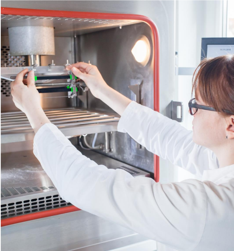
Abb. 7: Durchführung einer Ozonprüfung: Mitarbeiterin des O-Ring Prüflabor Richter vor einem geöffneten Ozonschrank
