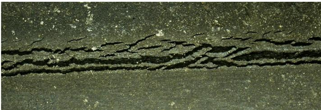
Abb. 3: Risse an einem statisch vorgedehnten Faltenbalg aus einem BR/IR-Elastomer
