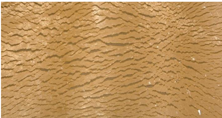
Abb. 4: Ermüdungsrisse an einer FKM-Membran
