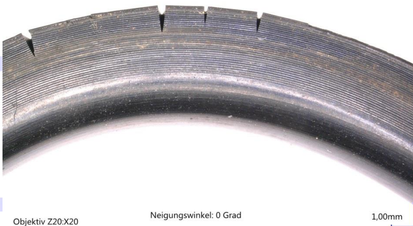
Abb. 3: Versprödeter NBR O-Ring zeigt beim Biegen Risse (umlaufende Riefen sind ein Abdruck der Gegenfläche) Abgrenzung zu Ozonrissen: Verhärtung rissiger Zonen. Bei Ozon- oder Ermüdungsrissen sind Risse in der noch elastischen Elastomermatrix.
