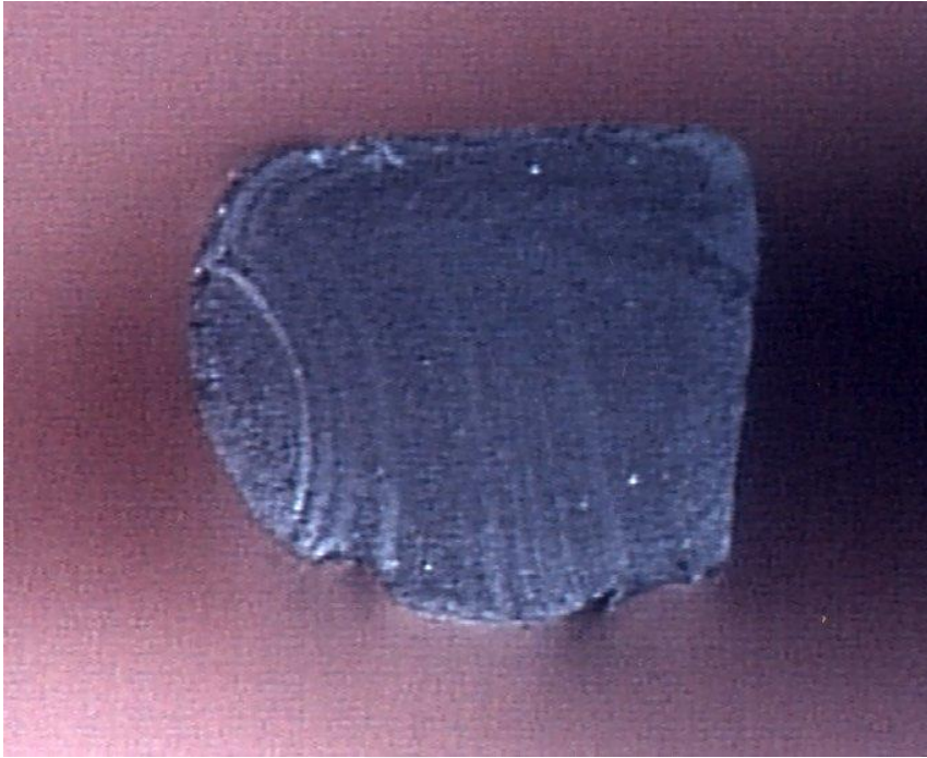
Abb. 2: Querschnitt eines stark überhitzten O-Rings (kurze Betriebszeit) durch trockenen Anlauf einer Gleitringdichtung, auffällig sind bleibende Verformung und nur lokale Versprödung, der Kern ist noch voll elastisch.
