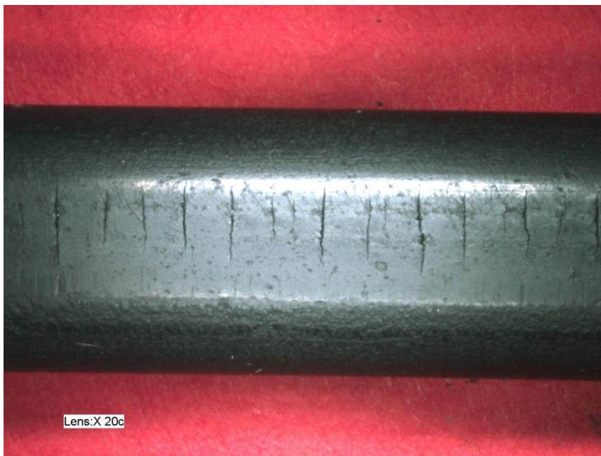
Abb. 1: Thermisch geschädigter O-Ring, komplett durchgehärtet, beim Biegen Risse an Anlageflächen sichtbar
