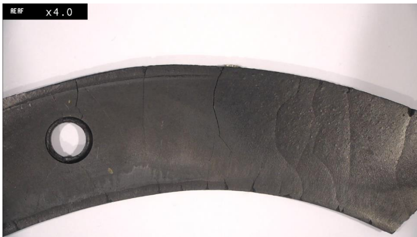
Abb. 4: Tatsächlich eingesetzter Werkstoff war NR, der Soll-Werkstoff wäre EPDM gewesen, Ausfall durch Versprödung in einer Heißwasseranwendung
