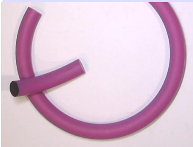
Abb. 7: Ursprünglich schwarzer O-Ring (siehe Schnittfläche) mit einer violetten Beschichtung
