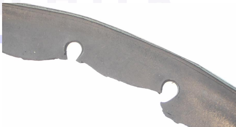
Abb. 1: Flachdichtung, in Öl gequollen, Sollwerkstoff: NBR, fälschlich eingesetzt: NR
