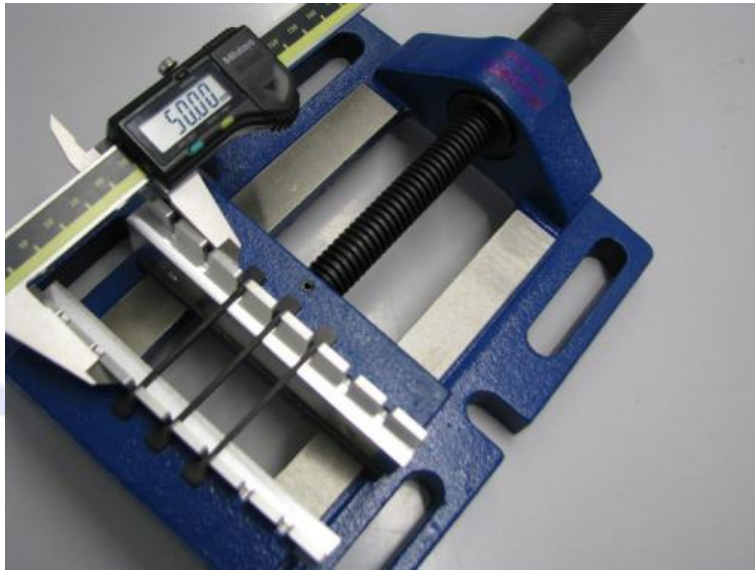
Abb1.: Zugverformungsrestprüfung: Normprobekörper in Ausgangslage, im noch entspannten Zustand (50mm)
