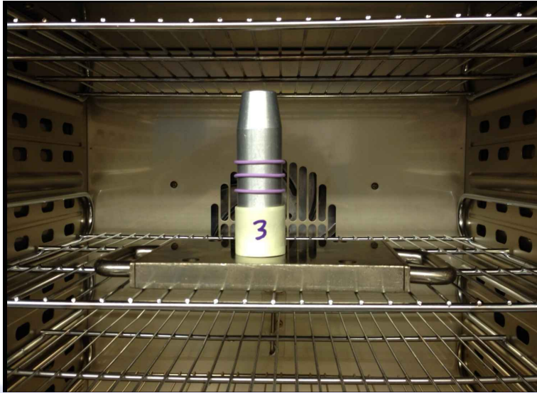
Abb3.: Zugverformungsrestprüfung an O-Ringen mit Hilfe eines Prüfdorns im Laborofen (radiale Dehnung)
