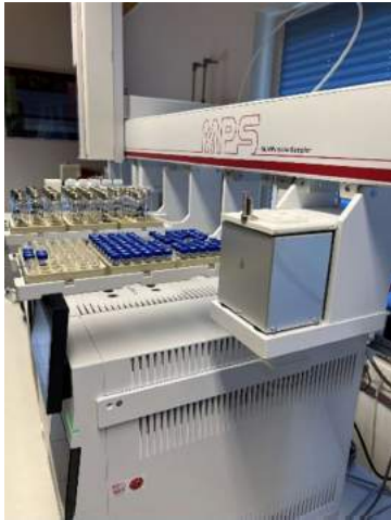
Abb. 3: heizbarer (Schüttel)Rührer der statischen Headspace der Firma Gerstel.
