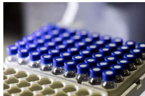
Abb. 4: Probengläschen zur Flüssiginjektion.
