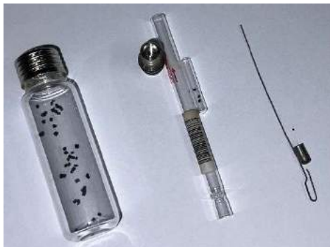
Abb. 5: Feststoffproben für die Headspace- (100 mg, links), Thermodesorption- (1.5 mg, Mitte) und Pyrolyse-GC/MS (0.15 mg, rechts).
