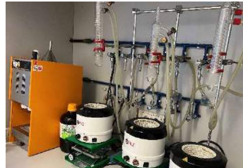
Abb. 6: Soxleth-Extraktionsapparaturen zur Extraktion von Additiven aus Elastomeren und anderen Polymeren.
