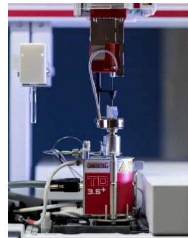
Abb. 2: Thermodesorptionseinheit (TD3.5+) mit Kaltaufgabesystem (CIS 4) der Firma Gerstel.
