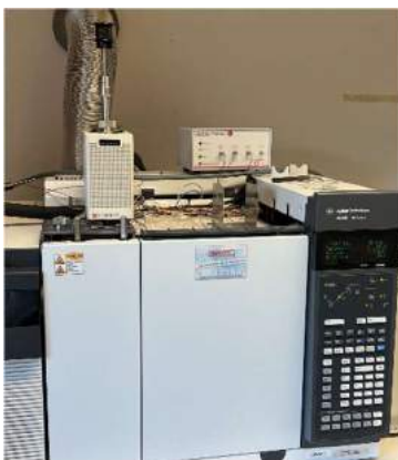
Abb. 1: GC/MS mit Pyrolyseeinheit der Firma FrontierLab
