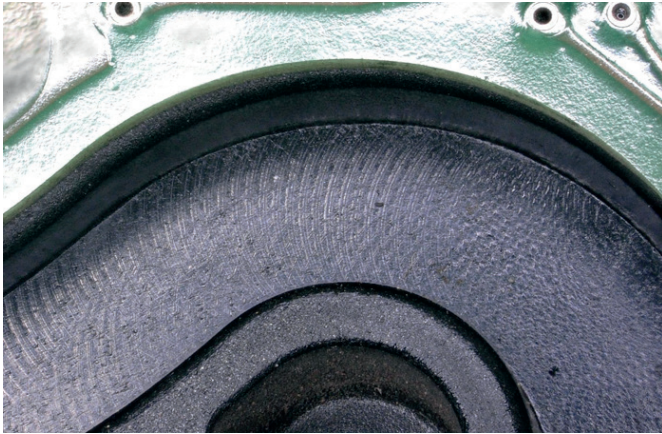
Bild 1: Ungünstige Oberflächenstruktur an der Dichtfläche eines Kunststoffbauteiles, durch die Riefen kann es zu einem frühzeitigen Überblasen kommen
