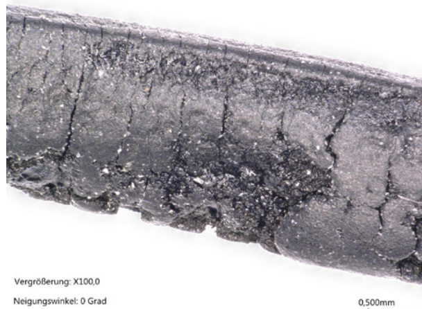
Bild 2: EPDM O-Ring, peroxidisch vernetzt nach einem Einsatz in einem überwachten Dauerversuch für eine Wasserarmatur (Schadensursache: Entzinkung von Messing, zyklische Temperaturwechsel von 25 °C bis 95 °C in Wasser, Versuchsdauer 4500 h)
