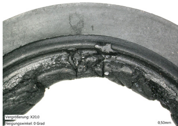
Bild 4: Ein durch Autoxidation geschädigtes Elastomer (peroxidisch vernetztes EPDM), das im Innenbereich des Dichtringes ganz deutlich aufgeschmolzene Bereiche wie bei einem Thermoplast oder TPE aufweist.
