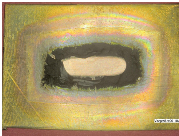
Bild 9: Überreste einer großflächigen Verklebung eines Probekörpers auf einer Kupferplatte: Ein solches Elastomer gilt als anfällig für Autoxidation.
