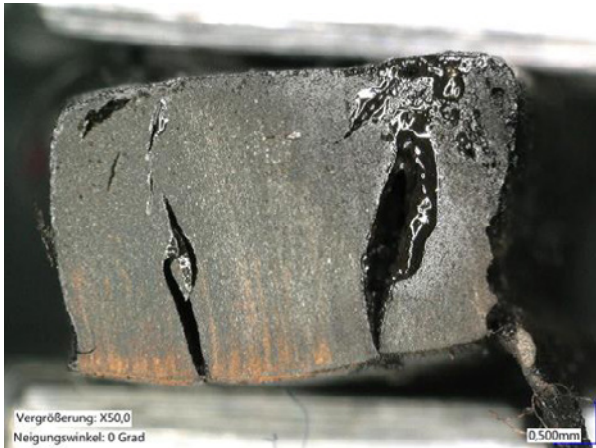
Bild 4: Innere Risse durch explosive Überhitzung bzw. explosive Verdampfung
