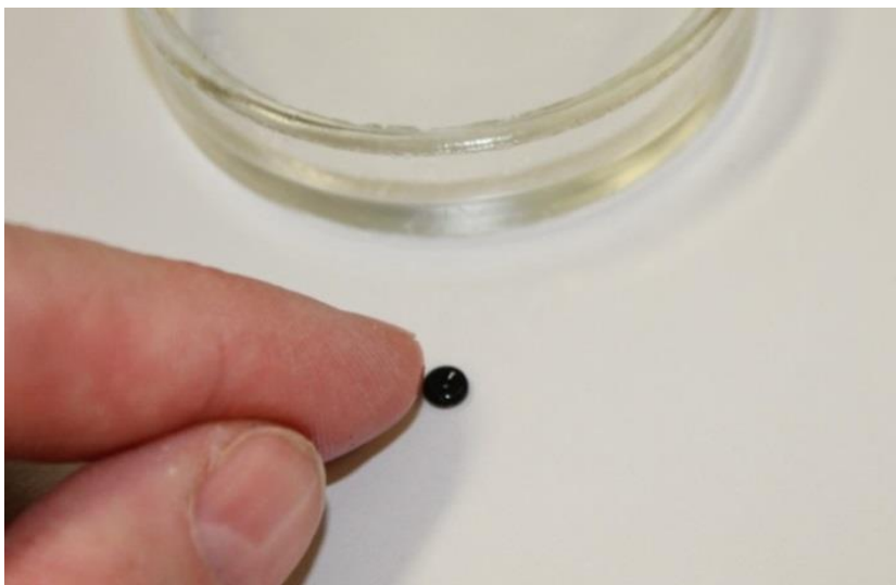
Abb. 1: Mikro O-Ring im Vergleich zu einem Finger (Bild: O-Ring Prüflabor Richter)
