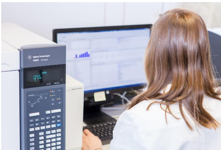
Abb. 2: Mit Hilfe eines Gaschromatographen mit Massenspektrometer (GC-MS) lassen sich Aussagen über die qualitative Zusammensetzung einer Gummimischung machen. (Foto: Tobias Ehmer)
