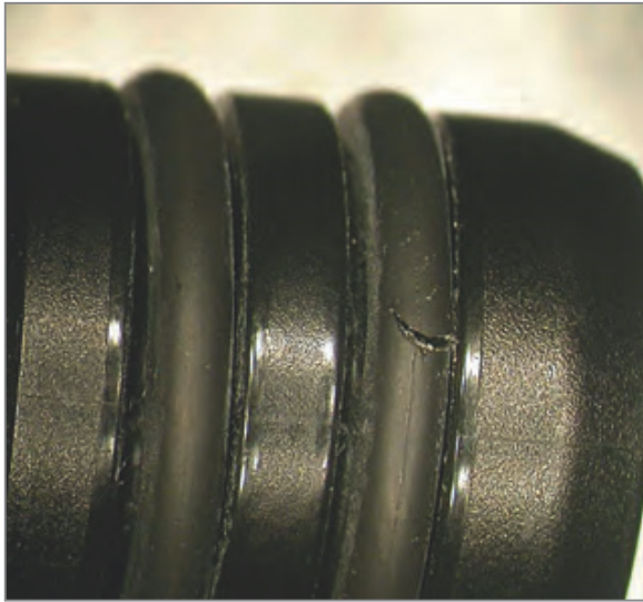
Bild 7: Riss aufgrund eines Vulkanisationsfehlers, erkennbar am parabelförmigen Rissverlauf symmetrisch zur Formtrennebene
