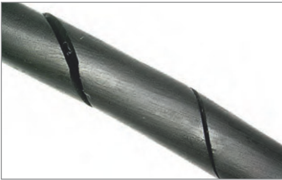
Bild 2: Spiralariss an einem O-Ring im fortgeschrittenen Stadium, bei weiterer Belastung käme es bald zu einem vollständigen Durchriss der Dichtung
