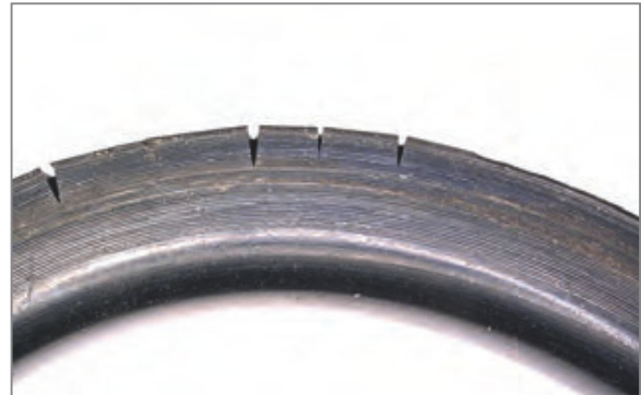
Bild 9: Versprödeter NBR-O-Ring zeigt beim Biegen Risse (umlaufende Riefen sind ein Abdruck der Gegenfläche) Abgrenzung zu Ozonrissen: Verhärtung rissiger Zonen. Bei Ozon- oder Ermüdungsrissen sind die Risse in der noch elastischen Elastomermatrix
