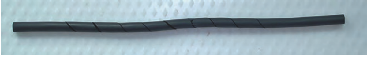
Bild 1: Umlaufende Spiralarisse an einem O-Ring: Gut erkennbar ist der typische 45°-Winkel. Ein geringes Verhältnis Schnurstärke zu Innendurchmesser begünstigt die Bildung von Spiralarissen
