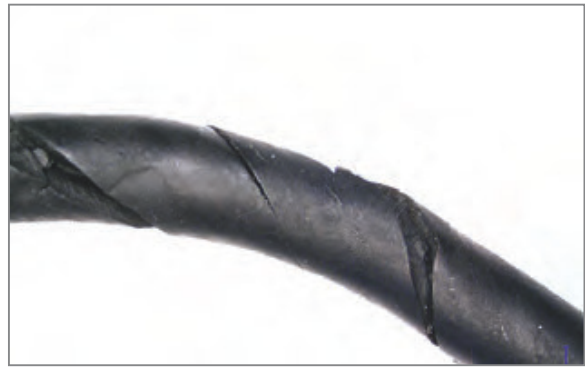
Bild 3: O-Ring-Spiralarisse im fortgeschrittenen Stadium (Bild: O-Ring Prüflabor Richter GmbH)
