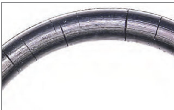
Bild 8: Typische Ozonrisse an einem O-Ring (radialer Verlauf in einem Winkel von 90° zur Umfangstangente)
