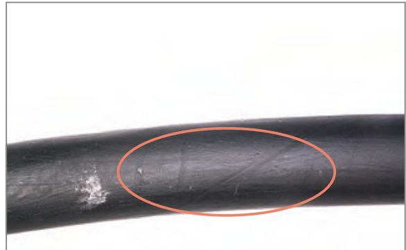
Bild 4: O-Ring mit leichten spiralförmigen Markierungen (rote Ellipse = Anfangsstadium eines Spirallisses)
