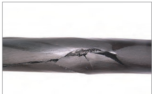
Bild 5: Spirallriss an einem O-Ring im fortgeschrittenen Stadium – kurz vor dem Durchriss
