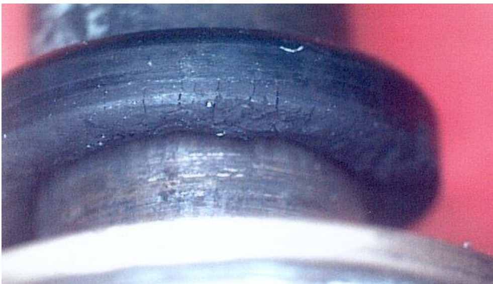
Bild 6: Thermisch überbeanspruchter NBR O-Ring, stark abgeflacht und rissig.
