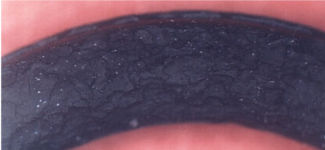
Bild 13: Schädigung durch ausgelöste und explosionsartig expandierende Luft.
